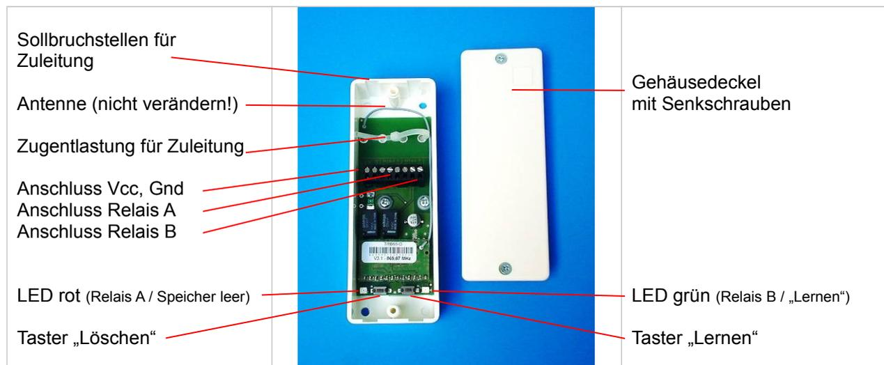
Der 2-Befehl-Empfänger FRT-RX-2 schaltet das Relais A bzw. B für jeweils ca. 2 sec., wenn gültige Funkbefehle eines eingelernten Senders FRT-HS2 empfangen wurden. An dem Empfänger können bis zu 10 Handsender eingelernt werden.
